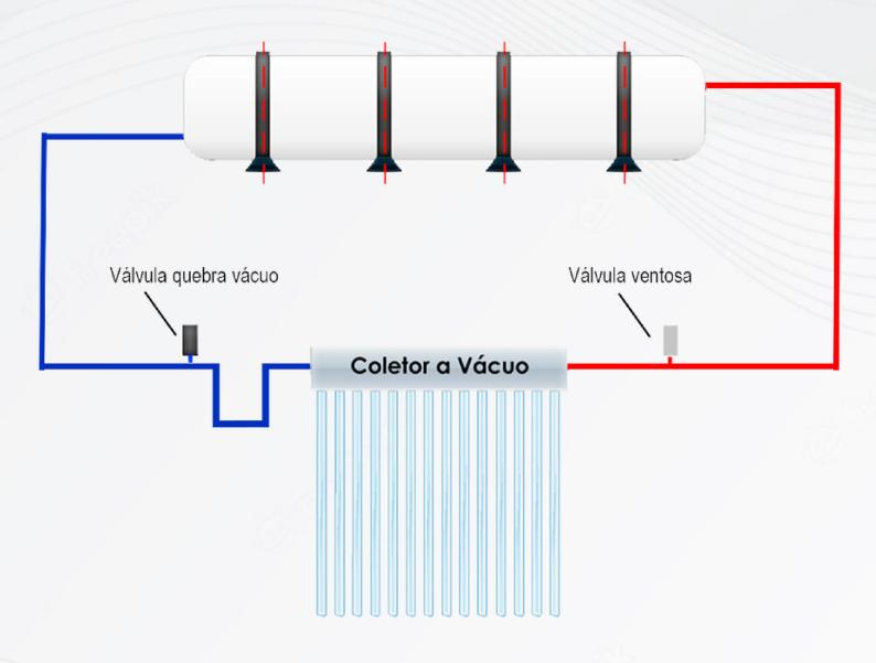
Os coletores a vácuo podem ser instalados sob uma pressão de até 5mca. Deve ser instalado com inclinação mínima de 30°Graus.
