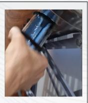
Ao posicionar o tubo no cabeçote, faça com que sobre um pouco de espaço entre a ponta do tubo e o apoio inferior, para que você possa puxá-lo afim de encaixá-lo corretamente no apoio.
